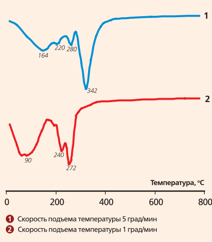
Рис. 5. ДИФФЕРЕНЦИАЛЬНЫЕ ТЕРМОГРАВИМЕТРИЧЕСКИЕ КРИВЫЕ ТЕРМООБРАБОТКИ ГРАНУЛ НОСИТЕЛЯ, ПРОПИТАННЫХ В РАСТВОРЕ НИТРАТОВ НИКЕЛЯ И АЛЮМИНИЯ
